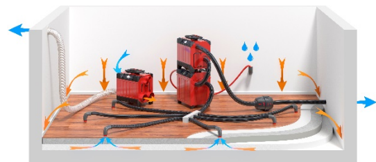
Vakuumtrocknung. Der Trockner trocknet die Luft im Raum, und die Turbine zieht Luft aus der Schichtkonstruktion nach oben, wodurch trockene Luft in die Konstruktion eingesaugt wird.
