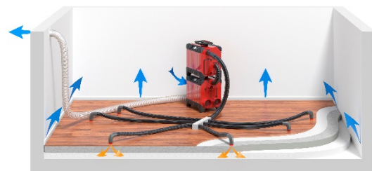
Drucktrocknung. Der Trockner versieht die Turbine mit Trockenluft. Danach drückt die Turbine die Luft in die geschichtete Konstruktion.
